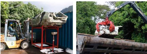
*Le véhicule nettoyé et dépollué est placé dans la presse. Compacté, il est dans un premier temps, stocké sur site puis placé dans un container à destination de FENUA MA à Motu Uta. Les containers sont ensuite acheminés vers la Nouvelle-Zélande pour un dernier traitement dans le cadre du recyclage des déchets et de la préservation de l'environnement.*
