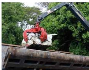
*Le véhicule nettoyé et dépollué est placé dans la presse. Compacté, il est dans un premier temps, stocké sur site puis placé dans un container à destination de FENUA MA à Motu Uta. Les containers sont ensuite acheminés vers la Nouvelle-Zélande pour un dernier traitement dans le cadre du recyclage des déchets et de la préservation de l'environnement.*
