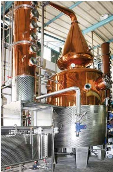
Cet alambic à col-de-cygne, a été fabriqué en Allemagne, chez l'un des meilleurs artisans. Il a été dessiné à la demande de MANUTEA Tahiti pour sublimer le rhum agricole MANUTEA. La technique de distillation mise en œuvre permet d'élaborer différents profils aromatiques.
