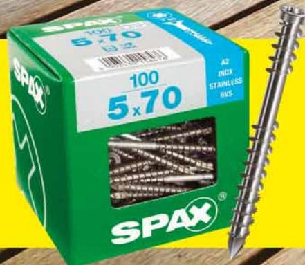
LA VIS SPAX EN INOX A4 OU A2 EST PARFAITEMENT ADAPTÉE À LA POSE DE DECK EN MERBAU. Sa pointe permet un placement précis, réduit l'épissurage du bois et sa petite tête est non seulement un atout décoratif mais permet aussi une prise d'outil sûre pour une transmission optimale des forces.
