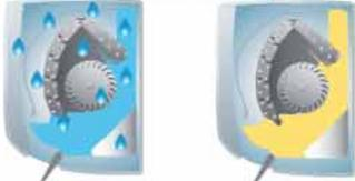
L'AvAnt, comme de nombreux modèles Toshiba, est équipé d'une fonction auto-nettoyante qui permet de réduire l'humidité, et ainsi les moisissures, dans l'unité intérieure. Lorsque l'AvAnt est en mode off, son ventilateur interne continue de fonctionner avant de s'arrêter automatiquement.
