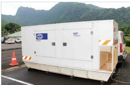
Groupe électrogène mobile de 250 KVA
