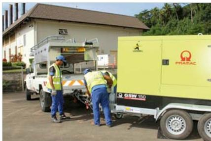
Groupe électrogène tractable de 150 KVA
