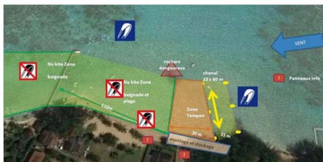
**1 – Zonage proposé de la zone littorale avec chenal de départ-retour balisé, zone de montage stockage des ailes et de mise à l'eau, zone tampon et zones totalement interdites à la navigation réservées à la baignade.**
